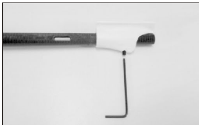
14. Наметьте положение хвостовой балки и крепления хвостового оперения. Закрепите крепление при помощи 3.6 мм винта как указано на фото. Отверстия для выхода тяг должны быть на одном уровне с креплением.
