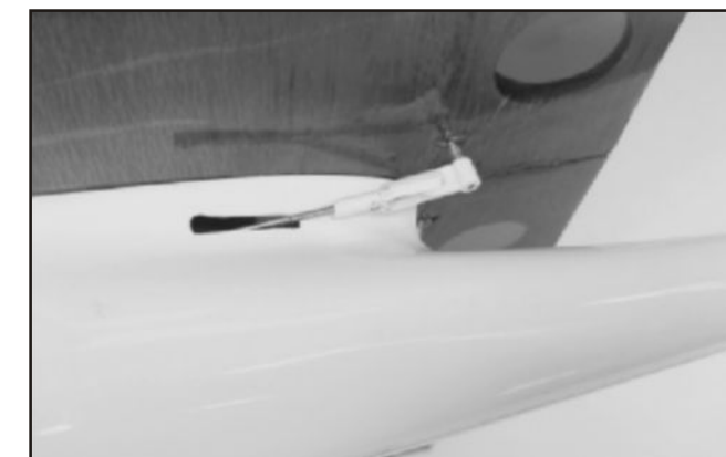
23. Снова установите основное крыло, защелкните карабины на кабанчиках контрольных поверхностей когда серво будет в нейтральном положении.
