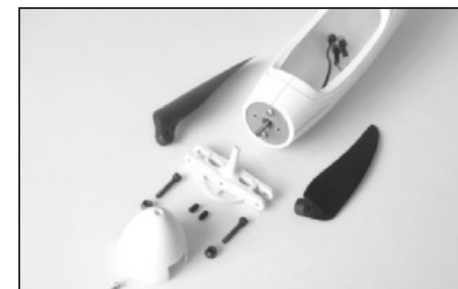
24. Закрепите мотор (рекомендуется Thunder Tiger OBL29/09-07A) при помощи винтов 3x5 мм. Убедитесь в том, что провода не соприкасаются с двигателем. При необходимости прикрепите скотчем. Расположите детали складывающегося пропеллера как указано.
